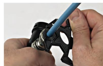
**2** Desligue o terminal de engate rápido, com a chave plástica
