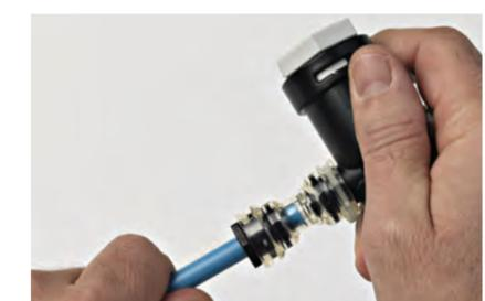
**3** Empurre o tubo para dentro do conector até que o veja pelo orifício de verificação para os tubos 20x2 e pela parte transparente para os tubos 8x1 . ext 20 – ext 20 - força de ligação 6 ÷16 kg (Dependendo das dimensões do tubo)
