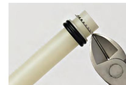
3 Retire o anel de fixação do tubo, com um alicate de corte.
