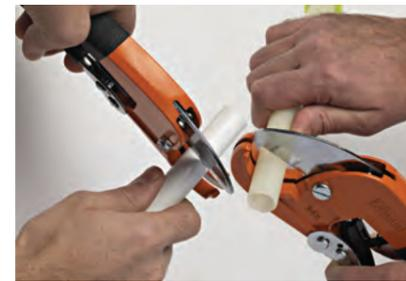
**1** Corte o tubo perpendicularmente utilizando um cortador de tubos.
