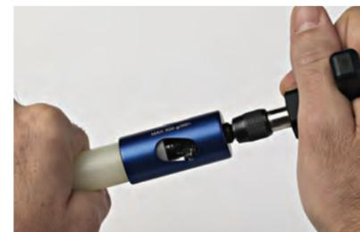
2 Faça estrias com o escareador no diâmetro externo do tubo, para facilitar a entrada no conector e para prevenir que ocorram danos nos o-ring durante a ligação (operação não necessária nos tubos
