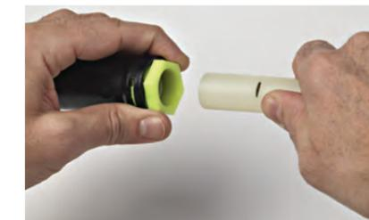
4 Empure o tubo para o interior da ligação até à que a marca efectuada anteriormente se encontre na ponta do conector.
