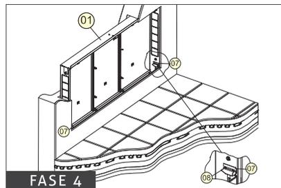
Antes de colocar la puerta, y dado que el armario tiene una profundidad de 80 mm, regular el soporte y base de la bisagra 07 de dicha puerta, desplazándolo hasta el ras del enlucido. Repetir la operación con el otro soporte.
