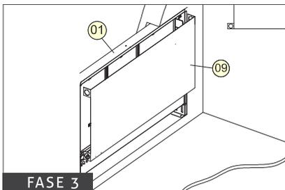
Antes de proceder al enlucido, colocar el protector de mortero 09 en el armario para poder mantener limpio su interior mientras se realizan estos trabajos de albañilería y según el caso, incluso los de pintura. El protector 09 se fija al cuerpo del armario 01 por las aletas que presenta en sus extremos y unos tornillos de mariposa.
