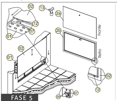
Después de realizar el paso 4, tome la puerta y deslícela hacia abajo (ver flechas) para que el soporte de bisagra 07 entre en la ranura 12. Una vez insertada la puerta proceder al cierre con llave 13 que encontrará en el embalaje.
