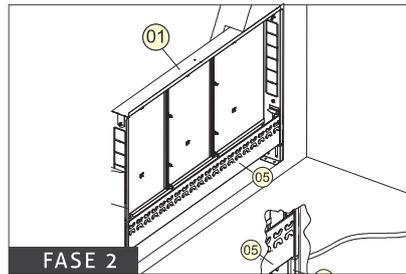
Después de haber creado el hueco, insertar el cuerpo del armario 01 en el mismo hasta que haga tope en el fondo. Posteriormente y con yeso o mortero fijarlo al muro 05.
